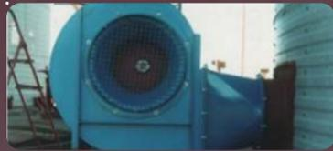
**VETILADOR CENTRÍFUGO INSUFLANDO AIRE SECO**
