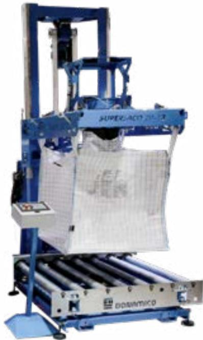
La llenadora **SUPERSACO 20-13** fue diseñada con el objetivo de lograr un equipo versátil que permitiera el llenado de big bag con una amplia variedad de productos granulados y pulverulentos, en bolsones de diferentes tamaños y distintos pesos. Puede cargar bolsones de entre 1 m y 2 m con posibilidad de pre programar distintos pesos de hasta 1500 kg y vibrados en el caso de ser necesario.
