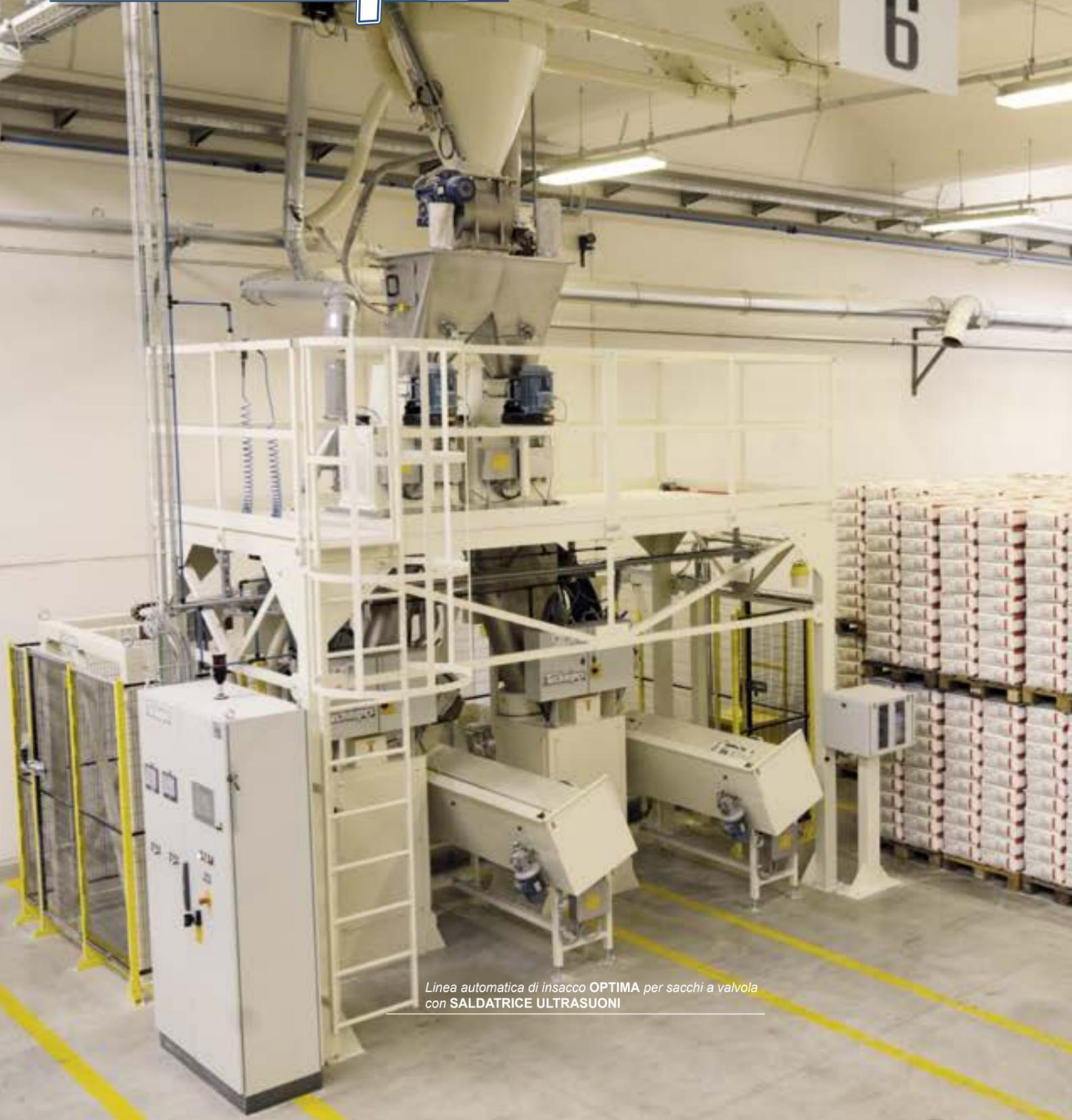
Linea automatica di insacco OPTIMA per sacchi a valvola con SALDATRICE ULTRASUONI
