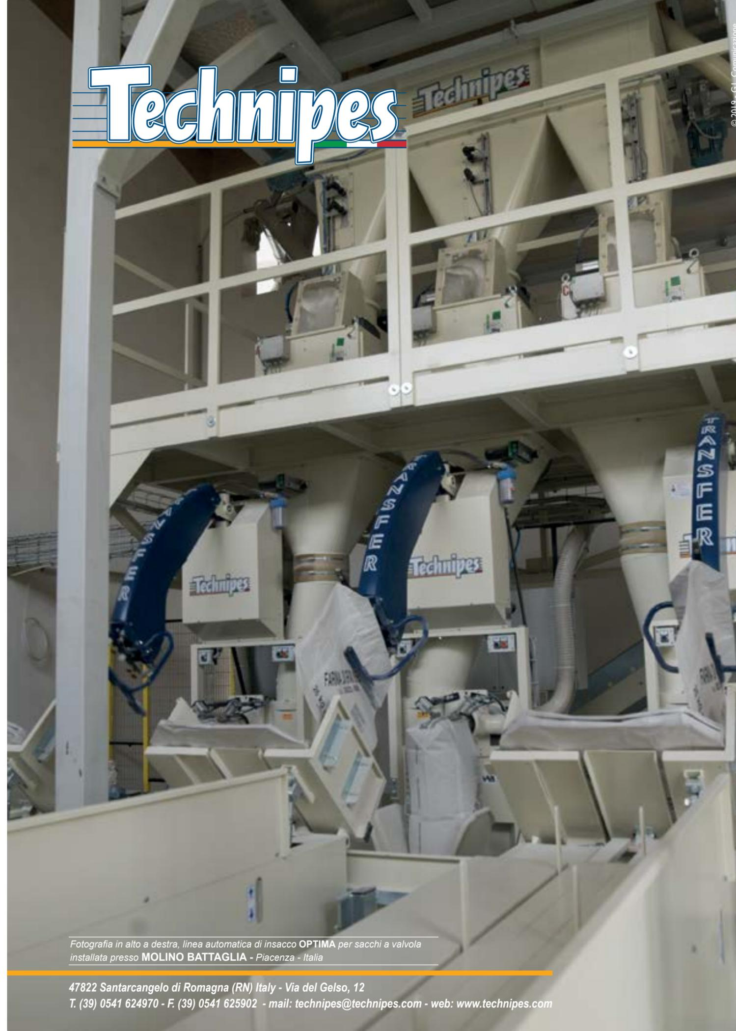
Fotografia in alto a destra, linea automatica di insacco OPTIMA per sacchi a valvola installata presso MOLINO BATTAGLIA - Piacenza - Italia
